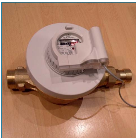
Rys 2. Rejestrator przepływu podłączony do wodomierza.
